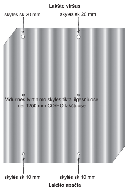
20 pav. Lakštas EUROFALA CO/HO – nupjautų kampų ir tvirtinimo skylių išsidėstymas.
