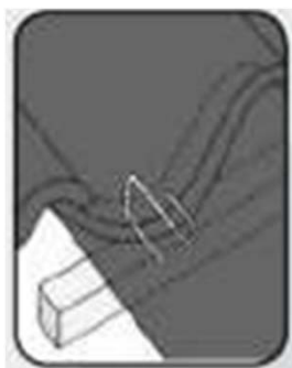
Brėžinys 70. VITTINGE S tipo čerpių laikiklis. Naudojami didesniam, nei 50° nuolydžiui, tačiau rekomenduojame jį naudoti visada.
